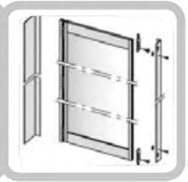
Klapp- bzw. schiebbare Schutzflügel zur Absicherung von Gefahrenstellen
