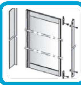
Klapp- bzw. schiebbare Schutzflügel zur Absicherung von Gefahrenstellen
