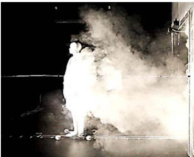
Abbildung 3: Luftbewegung bei geöffneter Drehtür nach dem Passieren (Quelle: Kalliomäki et al, 2015)
