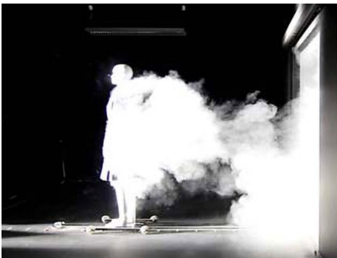
Abbildung 5: Luftbewegung bei geöffneter Schiebetür nach dem Passieren (Quelle: Kalliomäki et al, 2015)
