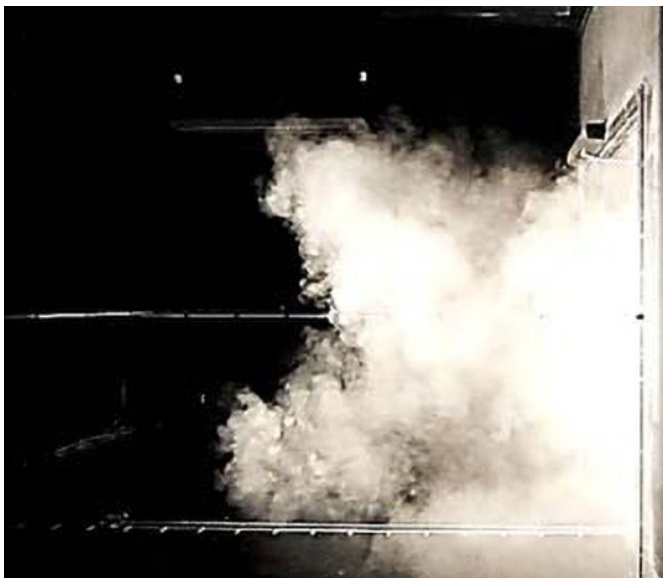
Abbildung 1: Luftbewegung nach Öffnen der Drehtür (Quelle: Kalliomäki et al, 2015)
