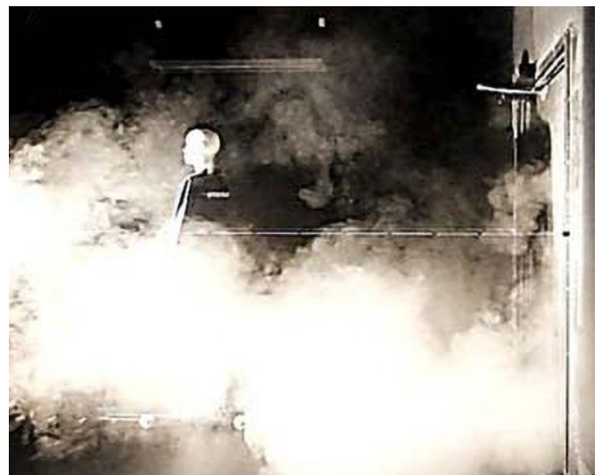
Abbildung 4: Luftbewegung bei geschlossener Drehtür nach dem Passieren (Quelle: Kalliomäki et al, 2015)
