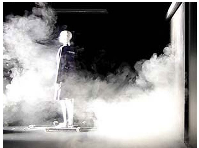
Abbildung 6: Luftbewegung bei geschlossener Schiebetür nach dem Passieren (Quelle: Kalliomäki et al, 2015)
