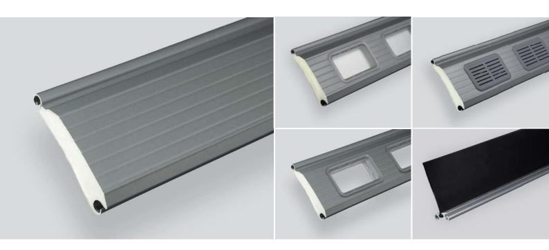
1.95 R est un profilé pour rideaux métalliques, garni de mousse dure, qui se caractérise notamment par son faible poids. Dans l'exécution standard en bande d'acier galvanisé revêtue de laque de protection transparente et dotée d'une résistance accrue, le poids correspond environ à celui d'un profilé d'aluminium 1.100 D.
