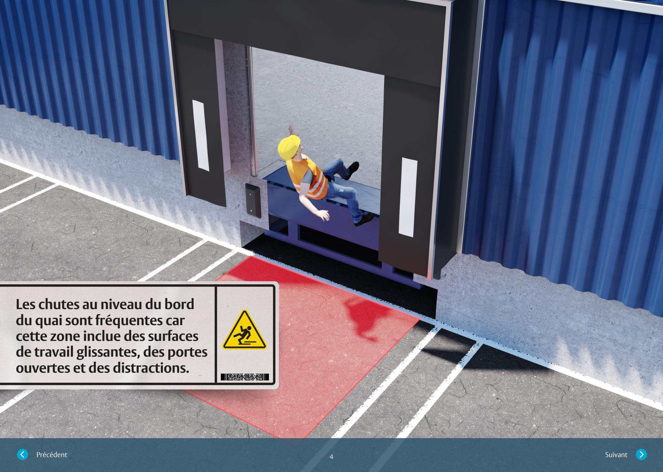
**Les chutes au niveau du bord du quai sont fréquentes car cette zone inclue des surfaces de travail glissantes, des portes ouvertes et des distractions.**
