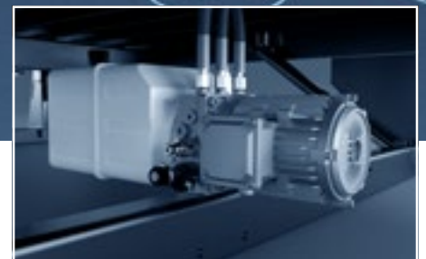
2. Hydraulisches Gehäuse, das Schwingungen während der Belastung reduziert und so die Lebensdauer und Zugänglichkeit für Serviceprüfungen erheblich verbessert
