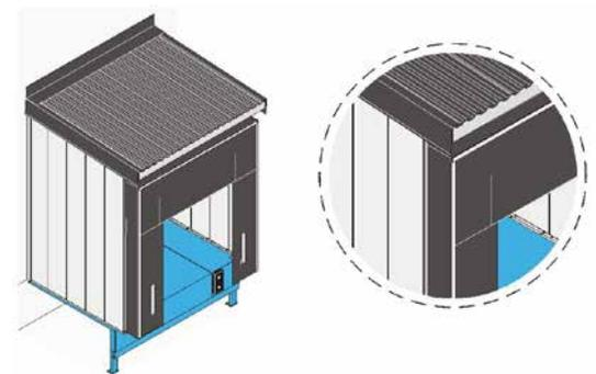
Vergrößertes Dach über mechanischer Torabdichtung
