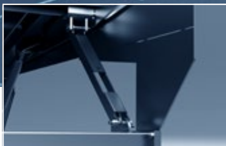
4. Les béquilles de sécurité à positionnement automatique améliorent la sécurité des opérations de maintenance et peuvent être mises en place par une personne seule en deux étapes simples
