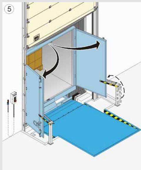
5 Les portes arrière du camion sont ouvertes sur la marche et fixées par les bloqueurs de la porte du camion.
