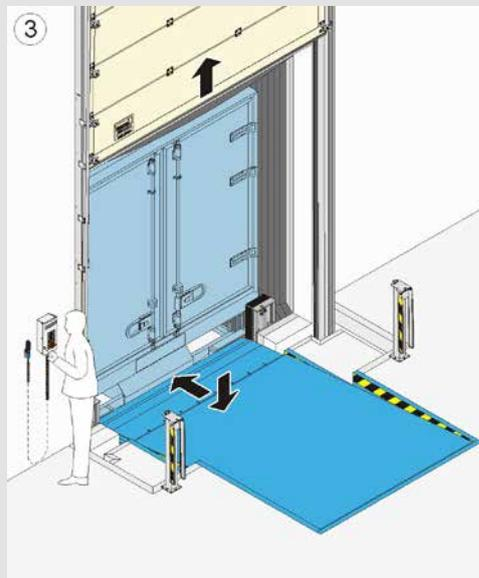
3 La porte sectionnelle est ouverte et la lèvres télescopique du niveleur de quai se projette pour combler l'espace entre le véhicule et le bâtiment.
