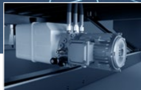
2. Le groupe hydraulique, facilement accessible aux opérations de maintenance, réduit les vibrations pendant le chargement, ce qui améliore considérablement la longévité
