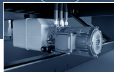
2. Hydraulhuset minskar vibrationerna under lastning för att väsentligt förbättra hållbarheten och tillgängligheten för serviceinspektion
